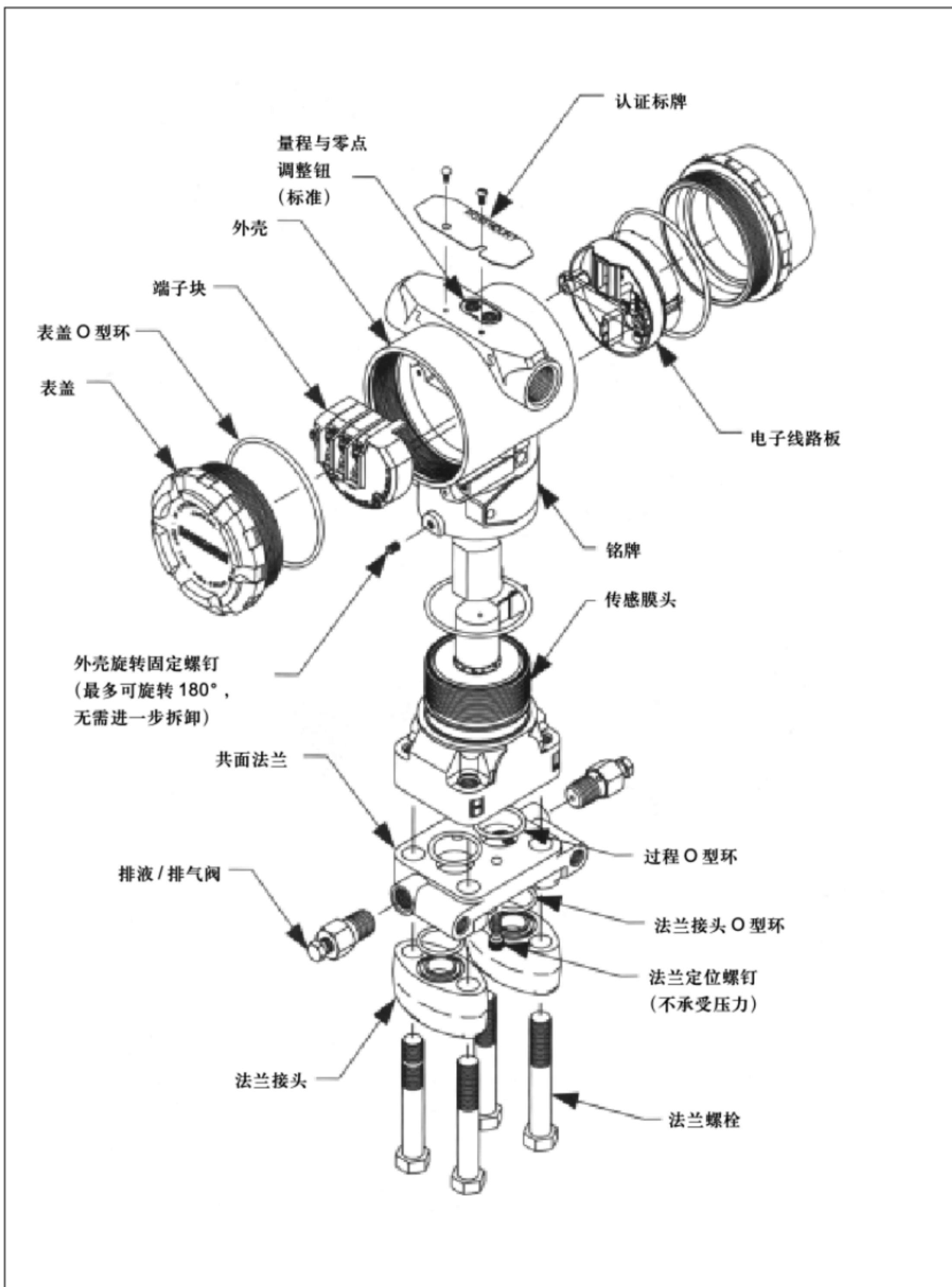
图 3. 3051C 型部件分解图
