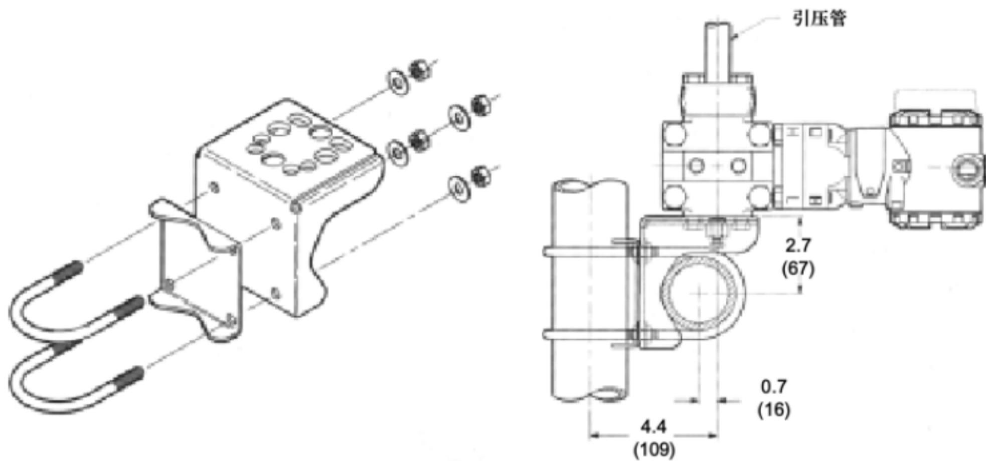
管道安装结构图
