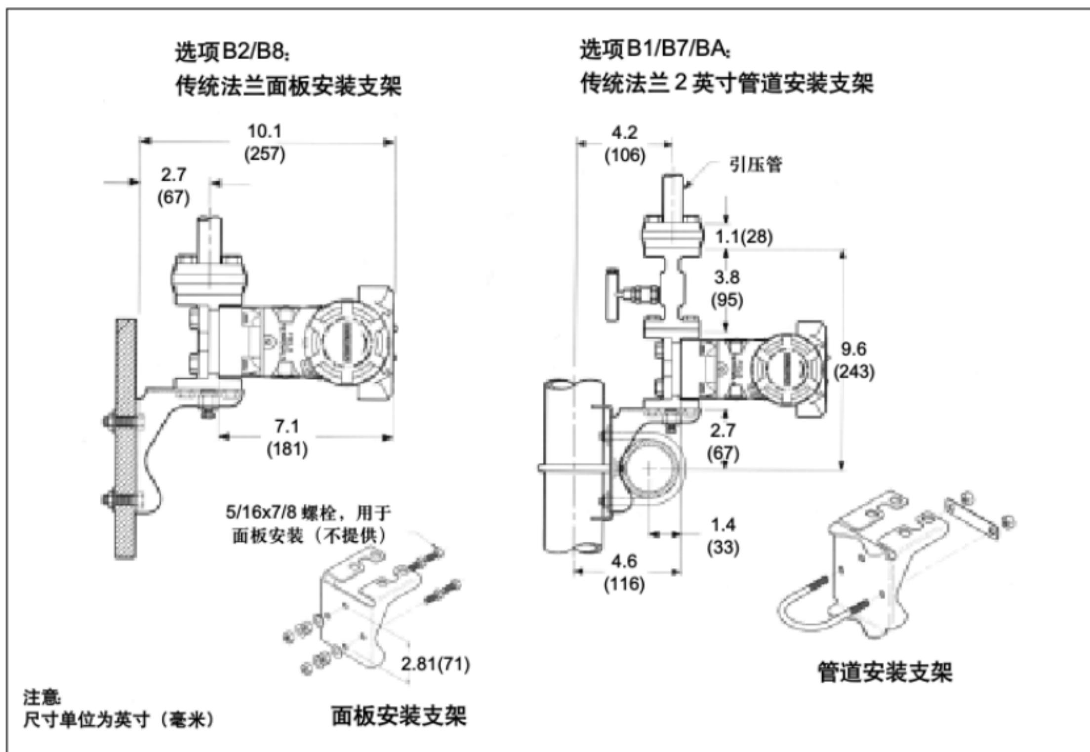
图 6. 传统法兰安装结构, 带有可选支架, 用于 2 英寸管道或面板安装
